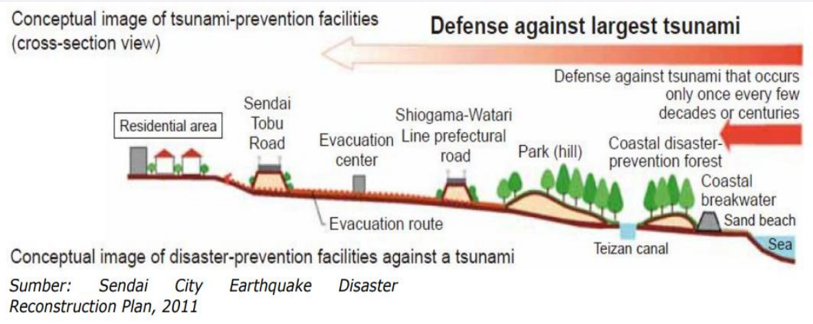
Contoh keratan rentas pertahanan, laluan kecemasan dan kedudukan pusat mangsa bencana tsunami
