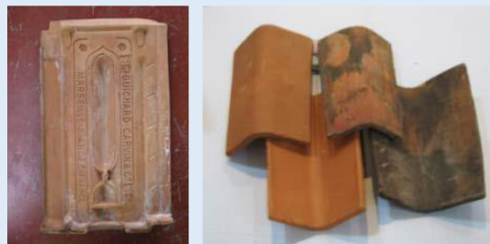
Foto 42: Contoh jenis-jenis genting yang pelbagai (atas), Genting Senggora (bawah kiri) dan Genting Mersiles dan Genting Bentuk V atau U (bawah kanan). Sumber: JWN.
