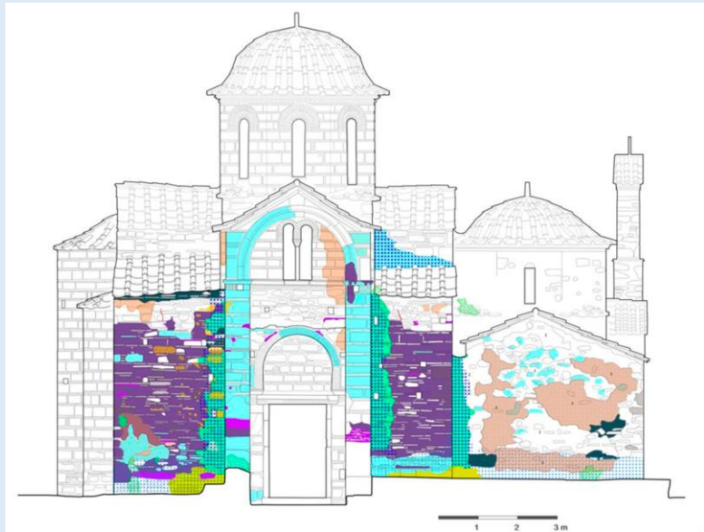
Foto 37: Contoh kaedah merekod dan memetakan cat asal bangunan warisan melalui pemetaan model bangunan dalam sistem komputer.
