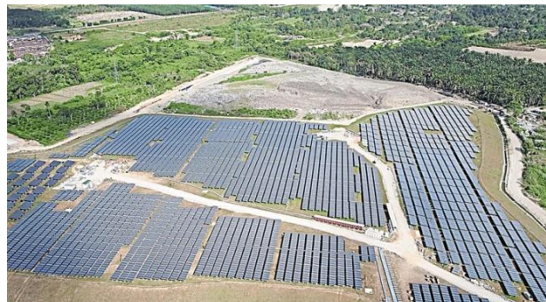
Contoh ladang janakuasa solar di Negeri Sembilan yang dibina di atas tapak pelupusan sampah yang telah di tutup selamat.
