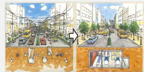
Foto: Kolam Tadahan Air Hujan, sistem penuaian air hujan, pembinaan sistem paip dan perancangan kemudahan common trenching
