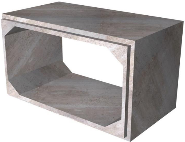
Contoh ilustrasi keratan rentas longkang culvert / bridge yang dicadangkan
