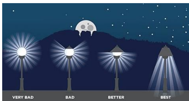
Foto 6.31: Contoh pengawalan cahaya pada lampu jalan perlu mempunyai corong penutup menghala ke tanah
