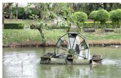
Ilustrasi Penggunaan Aerator dan Attached Media
